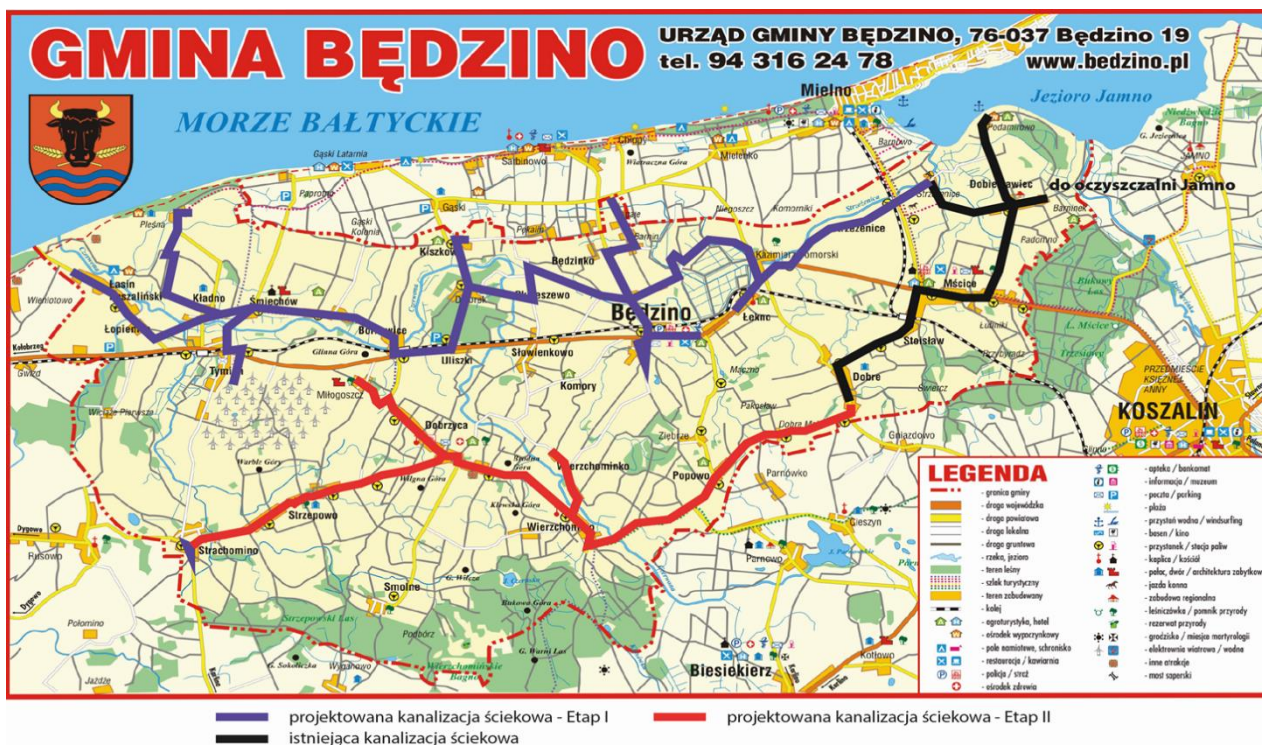
Ryc. 3. Schemat istniejących i planowanych do wykonania sieci kanalizacji sanitarnej w gminie Będzino Źródło: Archiwum własne
